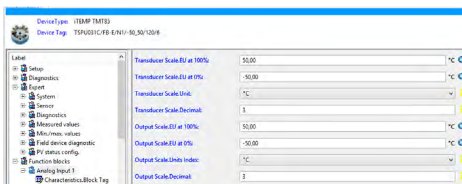
Рисунок И.13 – Выбор параметров выходного сигнала ППТ/ФБ-Е
