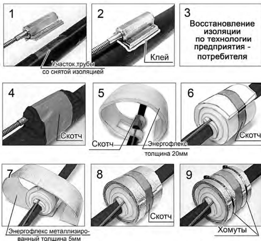
Рисунок 2.8 – Порядок работ по установке и креплению ПТП наземного исполнения с корпусом типа «К2» на трубопроводе с помощью КМЧ
