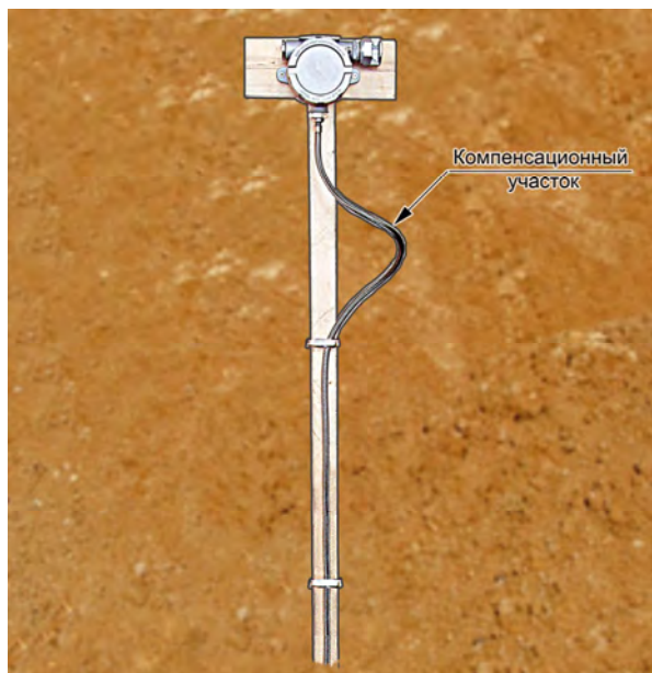
Рисунок 2.9 – Правильное положение головок типа «Г6», «Г6/1», «Г6/2», «Г7», «Г7/1», «Г7/2», «Г6М», «Г7М», «Г6Н», «Г7Н» с кабелем на основе гибкого рукава с оплеткой из стальных нержавеющих проволок на месте их установки
