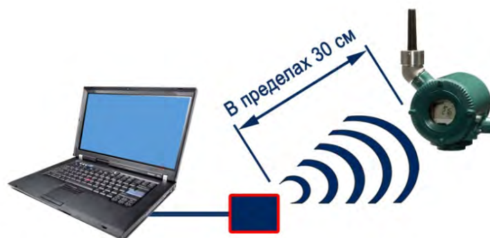
Рисунок Н.2 – Схема взаимного расположения ППТ/МБ и ИК-адаптера при проведении настройки
